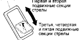
Переключатель выбора подвижных секций стрелы
