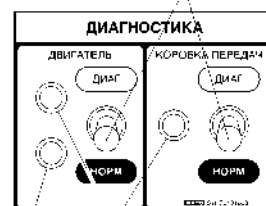
Контрольные лампочки диагностики (красные) Контрольная лампочка диагностики (оранжевая)
