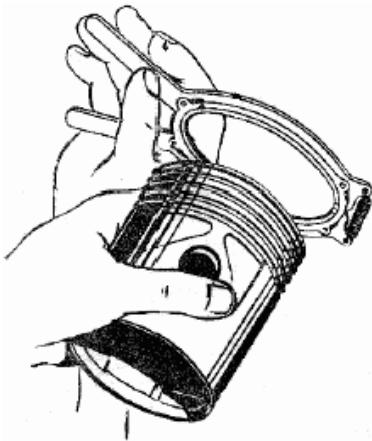
Фиг. 57. Приспособление для надевания поршневых колец на поршень.
