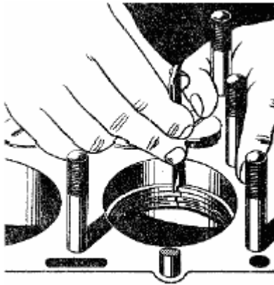
Фиг. 56. Проверка зазора в замках поршневых колец.
