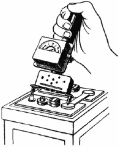
Фиг. 149. Проверка степени заряженности аккумуляторной батареи с помощью нагрузочной вилки.
